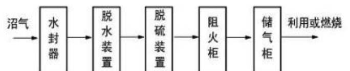
图 5 沼气净化系统图
